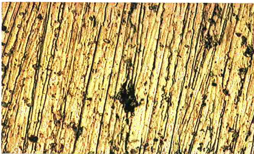
Figura 26 - Aspecto da liga AV2205 envelhecida por 60 minutos após ensaio potencioestático. 1000X.
